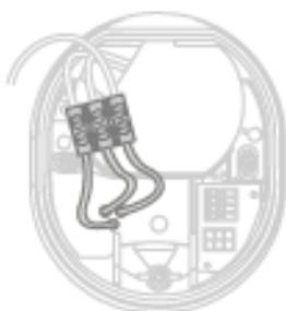
Conecte el cable conductor previamente pasado por la base, el conductor neutro y el conductor de puesta a tierra con la clema.
