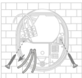
En la parte posterior de la base de la cámara, hay tres pequeños orificios para los tres hilos del cable de alimentación que debe suministrar tensión normal a la cámara. Pase los tres cables por la junta de goma en los puntos correspondientes. Asegúrese de que la longitud de los cables sea adecuada para la conexión a la clema de la base del soporte. Monte la base del soporte en la posición prevista para la cámara utilizando los tornillos adjuntos.
